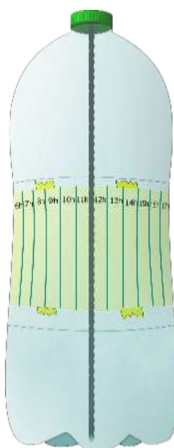
Figura 3. Dispositivo mostrador (garrafa + barbante + papel) completo.
